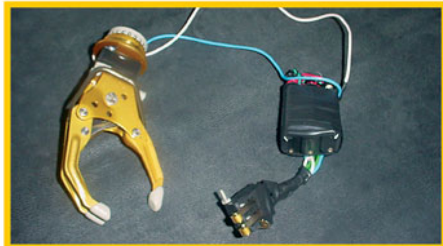
Mecanismo que compõe a prótese da mão.
