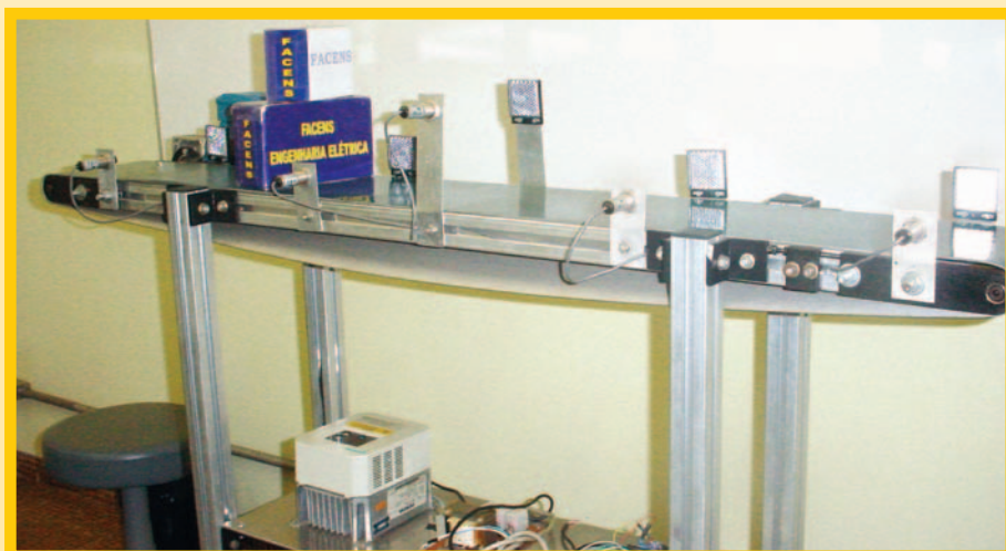
Fotos: esteira servirá para simular linha de produção
